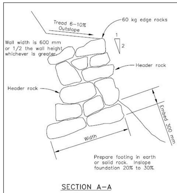
**Figure 30. Crib Wall Design**
